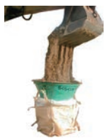
土のう充填機 (1トンバック用)
